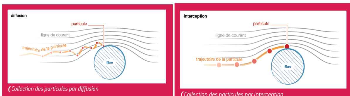
Fig. 28 : Schématisation des phénomènes de diffusion et d'interception qui régissent la filtration (Source INRS)
