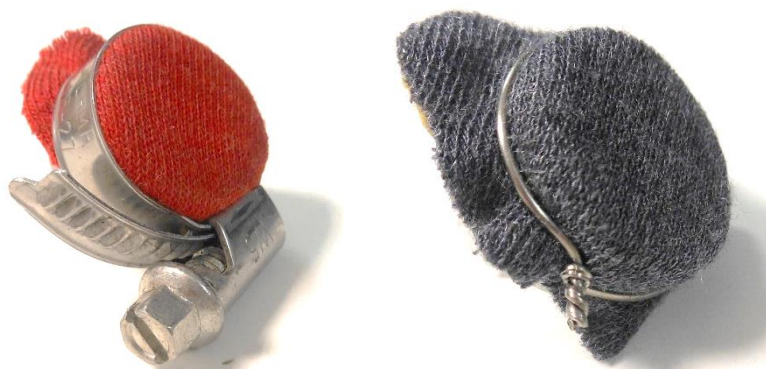
Fig. 52 : Élément de cagoule à tester et dispositif filtrant les particules fines
